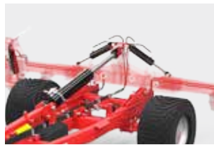
Гидравлическая регулировка работы с помощью держателя U910
