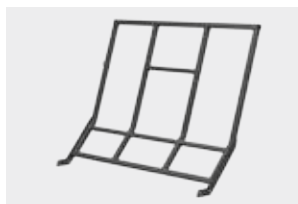
Измененная форма стены позволяет увеличить количество загружаемых рулонов.
