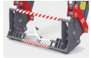
Крепление навесного оборудования - евро-рама
