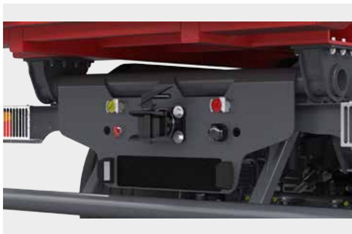
Медиа выходы (электрическое, пневматическое и гидравлическое соединение)
