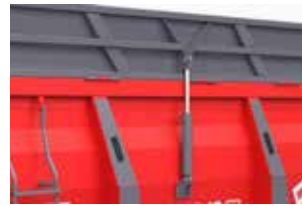
Возможность опускания и подъема гидравлического надставного борта. Управление осуществляется из кабины трактора
