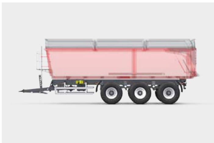
Подвеска тридем с первой и третьей осью торсионной пассивной - фиксированная центральная ось.
