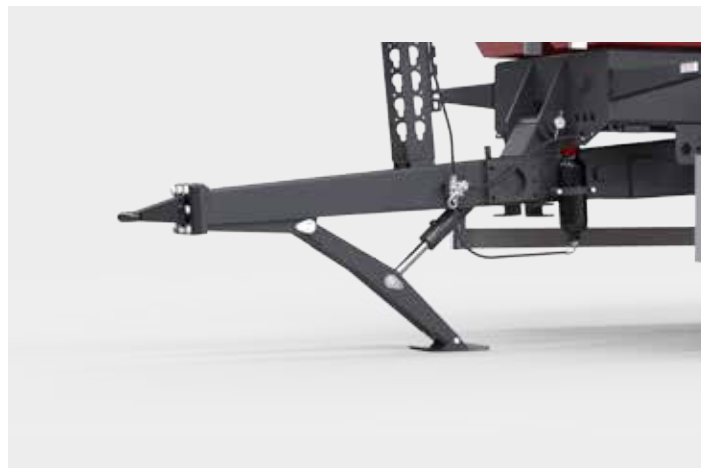
Опорная пята ножничного типа с гидравлическим управлением
