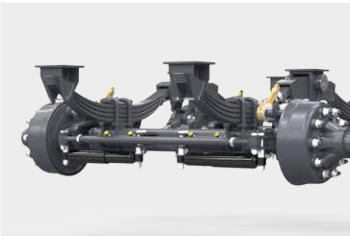
Гидравлическая стабилизация оси
