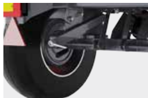
Стояночный ручной тормоз с кривошипной рукояткой
