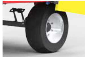
Шины Delcora - усиленные 30/11,5 14,5
